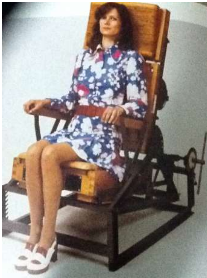
Foto 1: cadeira utilizada pela Giroflex desde 1964 para a avaliação antropométrica das diferentes populações.
