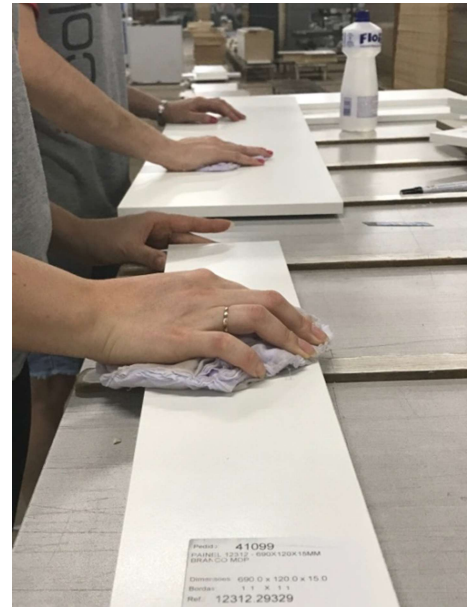
Figura 8: Painéis em MDF prontos e etiquetados, passando pelo setor de limpeza e verificação da qualidade, antes de seguirem para o setor de embalagens. Fonte: arquivos Casa 10 Ambientes
