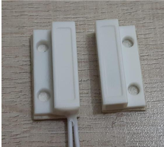
**Figura 4: Sensor Magnético com fio**
