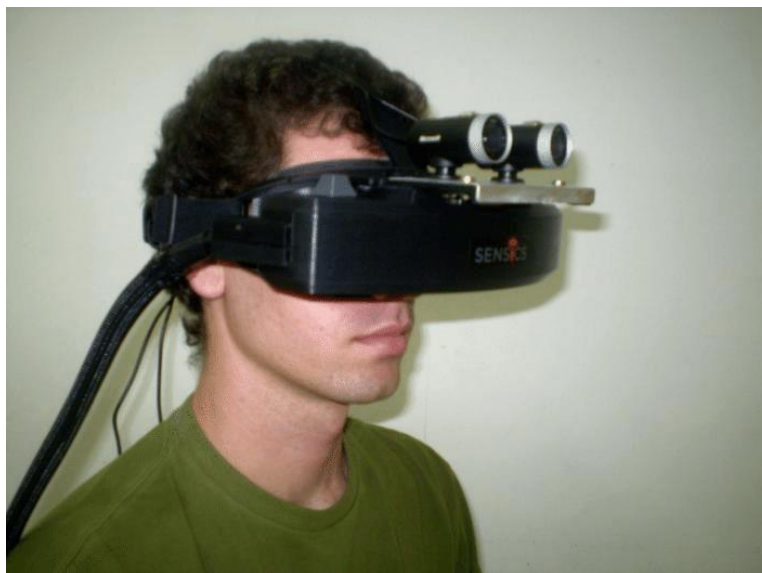
Figura 6. Usuário utilizando video see through (piSight ultrapanorâmico HMD)
