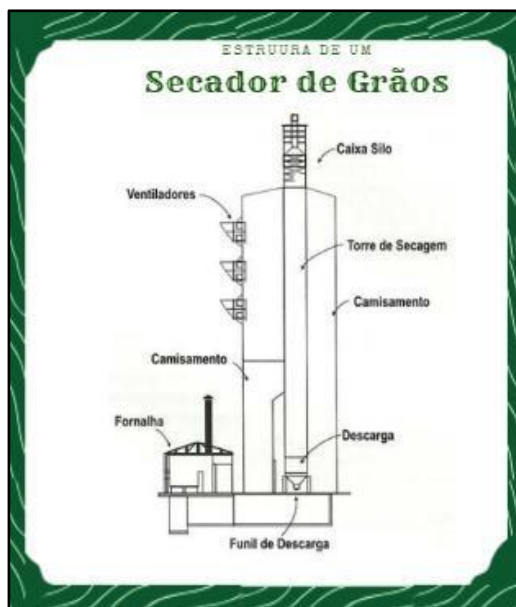
Figura 6 - Estrutura de um equipamento de secagem de grãos. Fonte: MIURA et al, 2015.
