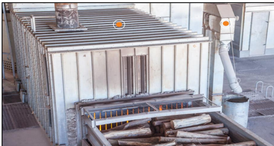
Figura 8 - Fornalha, sistema de secagem manual a lenha. Fonte: Kepler Weber, 2023.
