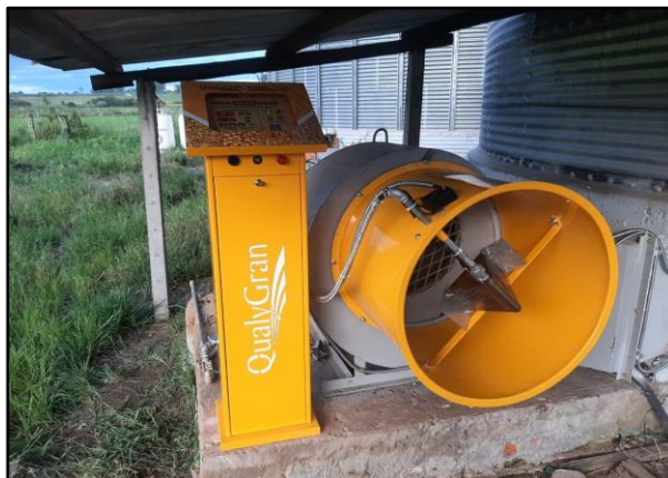
Figura 9 - Sistema de secagem a gás GLP. Fonte: Acervo próprio do autor 2024.
